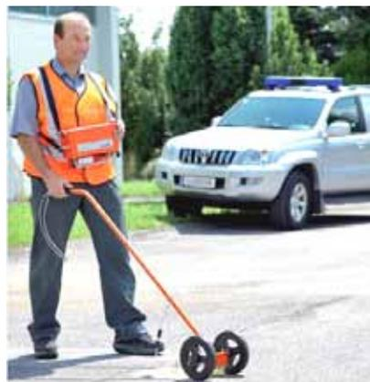
unterirdisch verlegten Erdgasleitungen mit einem Gasspürgerät. Im Zuge der Überprüfung der Gebäudezuleitungen ist es eventuell auch notwendig, Privatgrundstücke zu begehen. Die damit beauftragten Spezialisten der Netz OÖ weisen sich auf Verlangen selbstverständlich aus. Die Gebäude bleiben von der Begehung unberührt. Für die Wartungen der
